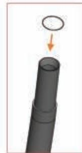
12. Compruebe que haya 1 junta tórica grande (35 mm de diámetro interior) en la sección del conector del brazo inferior.
