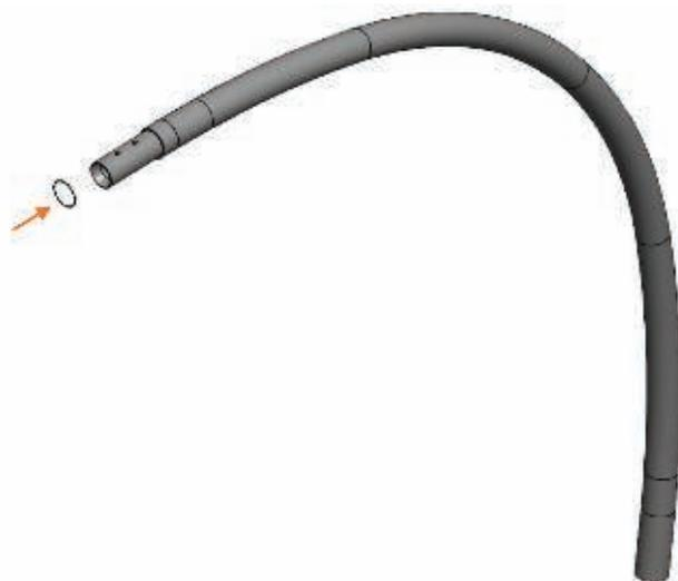
20. Compruebe que la junta tórica grande (35mm de diámetro interior) esté colocada en la sección del conector del brazo intermedio.
