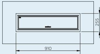
TELAIO DA INCASSO A SOFFITTO 2300W
