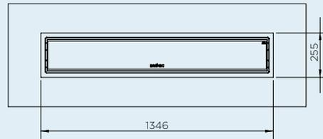
TELAIO DA INCASSO A SOFFITTO 4500W
