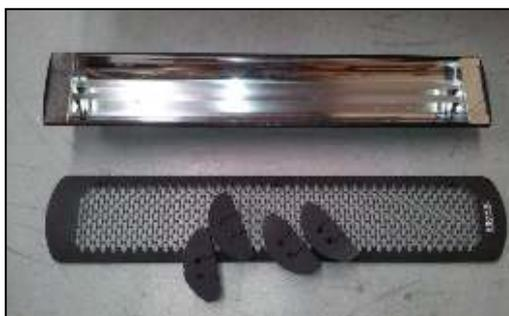
4. Verificare le marcature degli elementi ad entrambe le estremità dell'apparecchio. Accertarsi che le marcature sull'elemento riscaldante siano allineate con le marcature sul tappo terminale.
