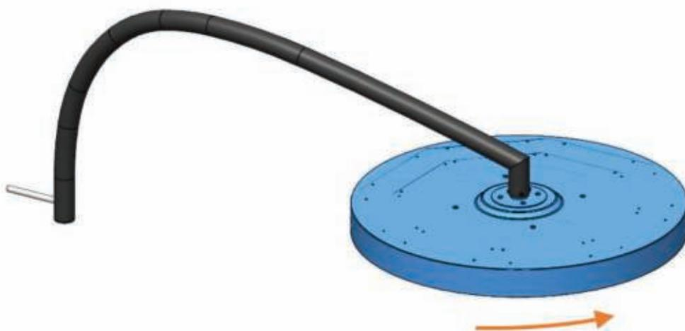
7. Inserire completamente 2 viti a cupola aggiuntive (M4 - Lunghezza: 6 mm) su entrambi i lati e serrare tutte e quattro le viti per bloccare il riscaldatore in posizione.
