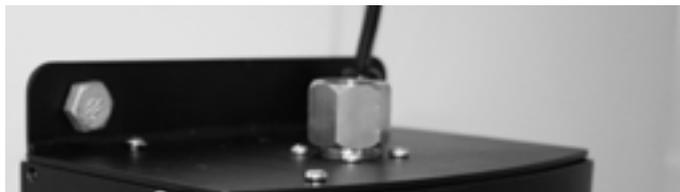
9. Fissare il coperchio anteriore all'alloggiamento usando le 8 viti x M4 (fornite). Il pannello anteriore deve essere assemblato con le 4 viti fornite in dotazione affinché l'apparecchio abbia grado di protezione IPX4.
