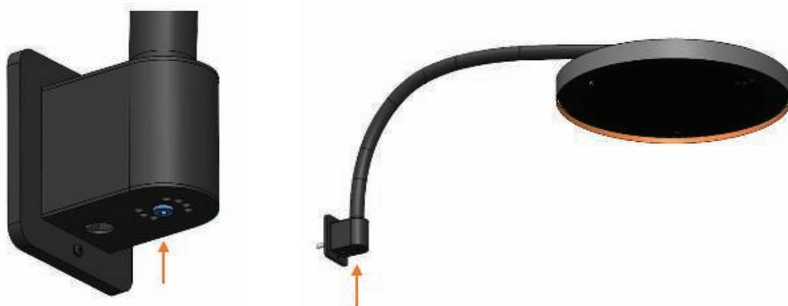
10. Verrouillez l'angle de la barre de montage mural au mur à l'aide de 2 vis à tête bombée (M6 - Longueur : 10 mm). L'angle du support mural peut être ajusté jusqu'à 45° par rapport au mur de chaque côté.
