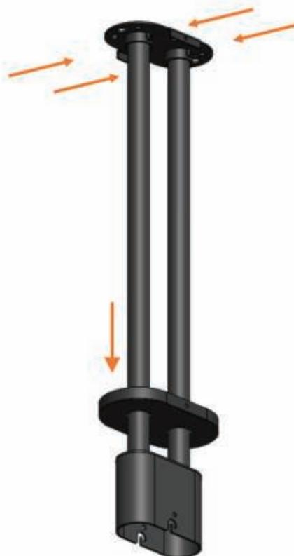
4. Faites glisser le bouchon de la double barre et fixez-le au support de la double barre à l'aide de 2 vis à tête bombée (M4 - Longueur : 6 mm).
