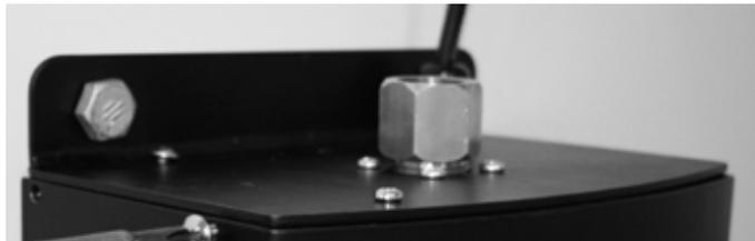
Ajuste todas las conexiones y abra el suministro de gas. Compruebe que no existen fugas de gas con una solución de agua jabonosa. (Consulte la sección titulada "Prueba de fugas").
